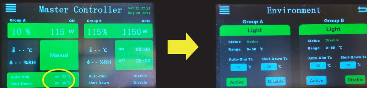
Muestra el modo “Auto Dim”. Muestra la temperatura ambiente y los datos de humedad relativa.
