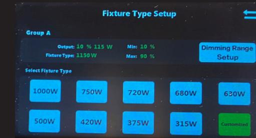
Toque “Configuración del tipo de aparato” para seleccionar el tipo de aparato y los niveles de potencia.
