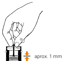
Introducir la Pieza Interior de la Cámara de Relleno
