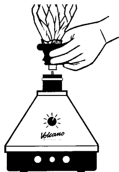
Unir el Globo de Válvula con la Cámara de Relleno
