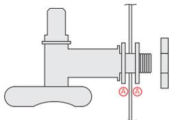
Introduce el grifo por el orificio del FlexiTank insertando cada arandela donde indicado con una (A). Enrosca el grifo a mano al máximo de forma que quede boca abajo.
